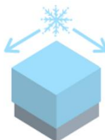
پ) ایجاد ترک های کوچک در سطح بتن در اثر انبساط آب
