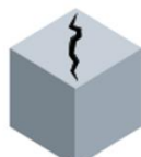
ت) ذوب شدن یخ و نمایان شدن آسیب های ایجاد شده در سطح بتن
