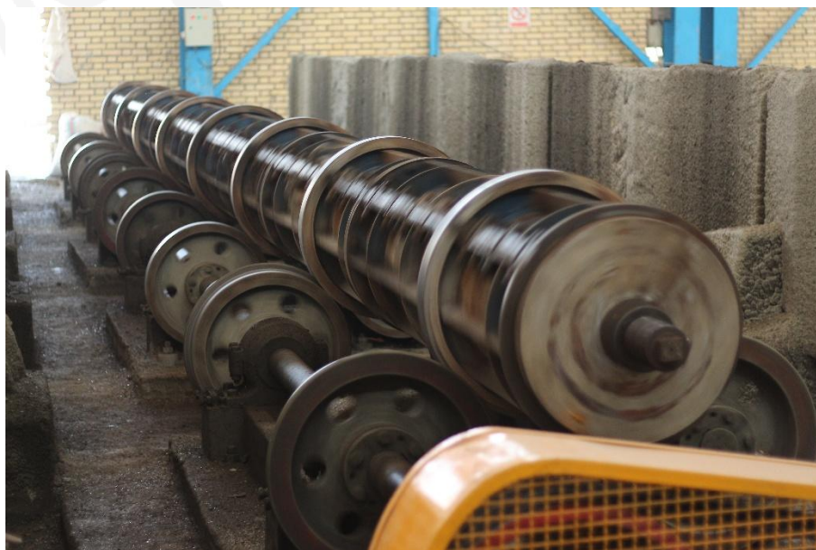
شکل ۱. عملیات سانتریفیوژ و اعمال نیروی گریز از مرکز
